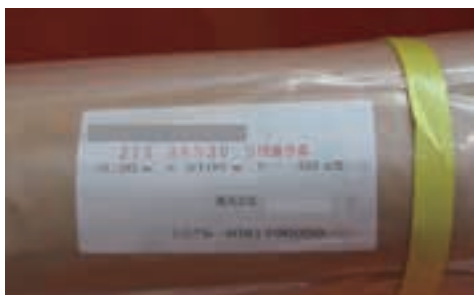
写真 3.2.1 防湿フィルムの JIS 適合品の例
