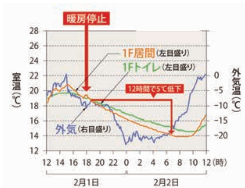
図 2.2.13 厳寒期の平成 11 年基準対応住宅の実測結果 出典：道総研建築研究本部 測定結果
