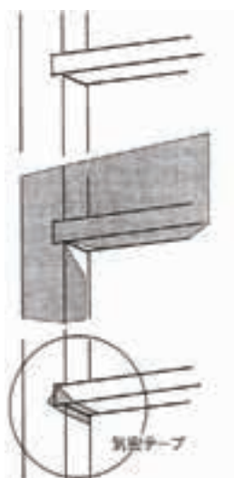
図 5.6.1 開口部の気密化方法
